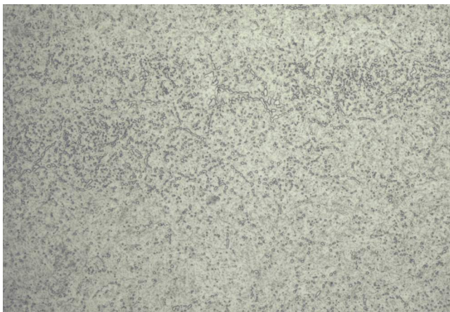
THYROPLAST-2083 ESU SUPRA Inhomogene, ungleichmässige Karbidverteilung 500x
