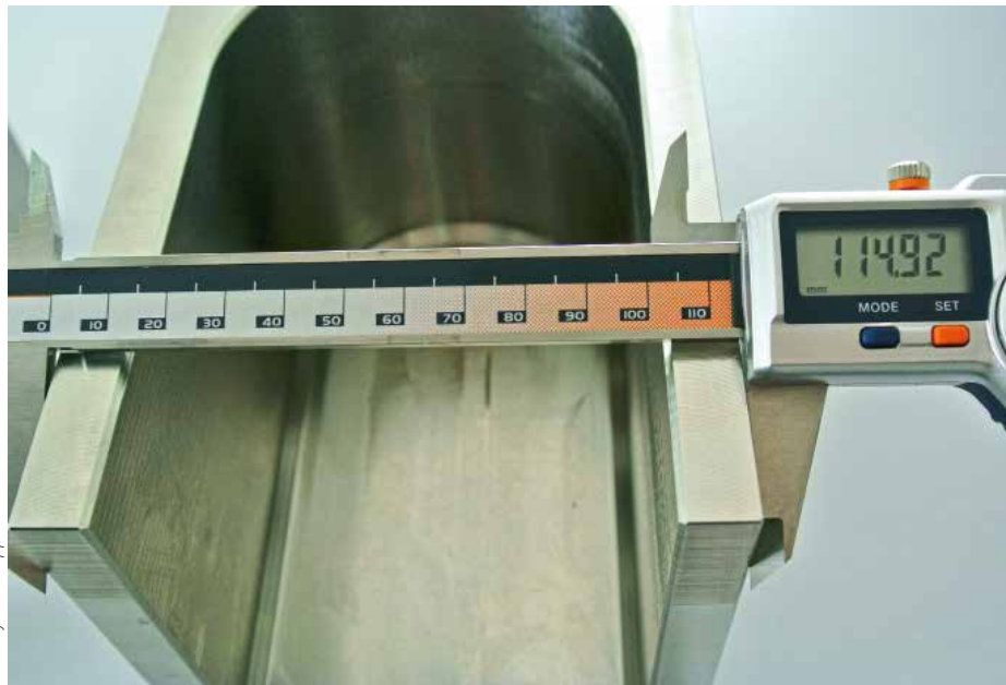
Bauteil aus verzugsarmem Edelbaustahl-Blockmaterial CUBESTEEL nach umfangreicher Schrubbearbeitung; Ausgangsmass 115,00 mm.
