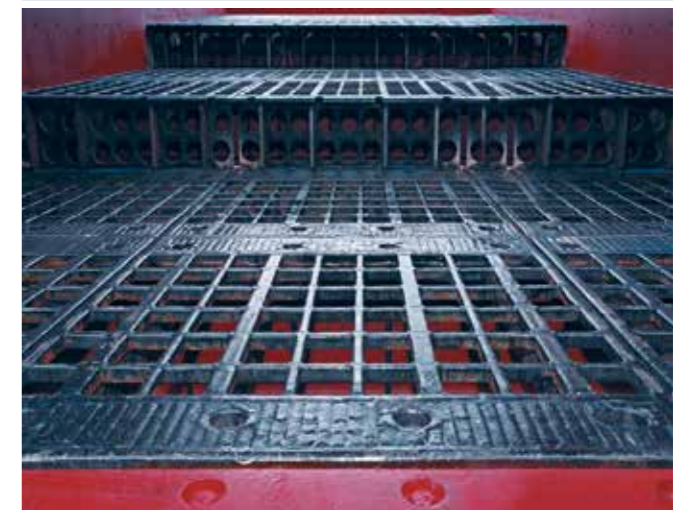
Linearschwingsieb Ölsandsieb mit Stufen Typ DU 64 – 3,6 x 8,0 (8,9) ED
