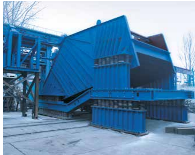
Isolierrahmen mit Schraubendruckfedern und Gummipuffern
