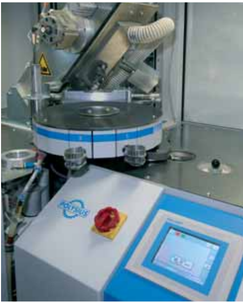
Estação automática de recebimento de cartuchos pneumáticos...
