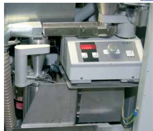
Integriertes Lasergrenulometer für Feinheitsanalysen von Zement- oder Rohmehlproben.
