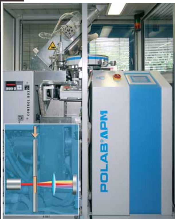
POLAB® ACT mit dem Kernstück der Probenaufbereitung – dem integrierten POLAB® APM.
