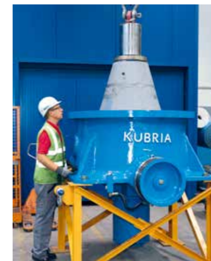
Wechsel der Brechwerkzeuge beim Kubria® Kegelbrecher
